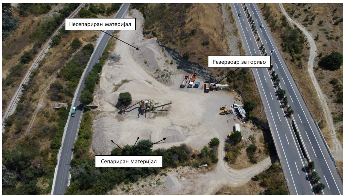
Слика 13 Складирање на сировините во рамки на постројката за сепарација
