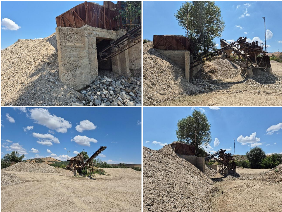
Слика 8 Приемниот бункер и машината за сепарација со транспортни ленти
