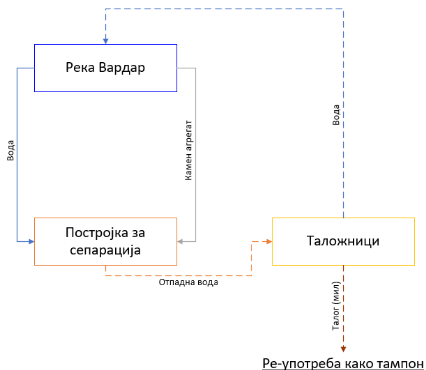
Слика 16 Шема на зафаќање и испуштање на вода од река Вардар
