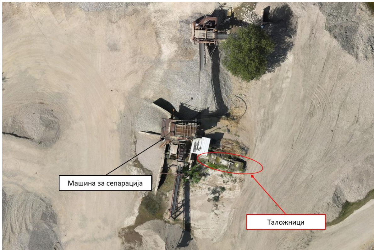
Слика 14 Поставеност на таложниците во однос на машината за сепарација
